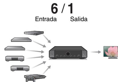
Esta unidad está equipada con 6 entradas HDMI y 1 salidas HDMI que permiten la conexión a varios dispositivos compatibles HDMI, como por ejemplo reproductores Blu-ray Disc, consolas de videojuegos y videocámaras de HD.
