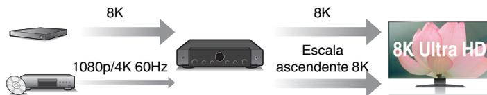
Esta unidad está equipada con una función de escalado de vídeo de 8K que permite la salida de vídeo 1080p/4K a través de HDMI a una resolución de 8K (7680 × 4320 píxeles). Esta función habilita la conexión del dispositivo al TV utilizando un solo cable HDMI y produce imágenes en alta definición para cualquier fuente de vídeo.
