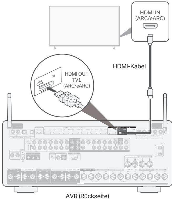
Verwenden Sie ein hochwertiges HDMI-Kabel\* und schließen Sie ein Ende an den mit "eARC" oder "ARC" gekennzeichneten HDMI-Anschluss an Ihrem Fernseher an. Schließen Sie das andere Ende an den HDMI OUT TV 1-Anschluss an Ihrem AVR an.
