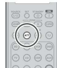
Si le signal d'entrée audio analogique sélectionné est plus élevé que le niveau maximum de traitement interne, l'indicateur « **PEAK** » s'allume sur l'afficheur avant. Si cela se produit, vous devez appuyer sur la touche **ATT** de la télécommande.
