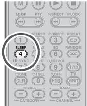
Pour mettre automatiquement l'appareil en mode STANDBY, appuyez sur la touche **SLEEP** de la télécommande.
