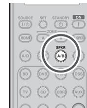
Le appareil comporte un système d'enceintes A et un système d'enceintes B aux canaux G/D avant. Vous pouvez sélectionner ces systèmes en appuyant sur la touche **SPKR A/B** de la télécommande.
