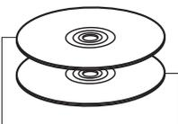
Super Audio CD double couche constitué d'une couche HD\* (haute densité) et d'une couche CD. Les signaux de la couche CD peuvent être lus par un lecteur CD classique.
