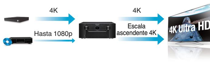
Esta unidad está equipada con una función de escalado de vídeo de 4K que permite la salida de vídeo analógico o SD (definición estándar) a través de HDMI a una resolución de 4K (3840 × 2160 píxeles). Esta función habilita la conexión del dispositivo a una TV utilizando un solo cable HDMI y produce imágenes en alta definición para cualquier fuente de vídeo.
