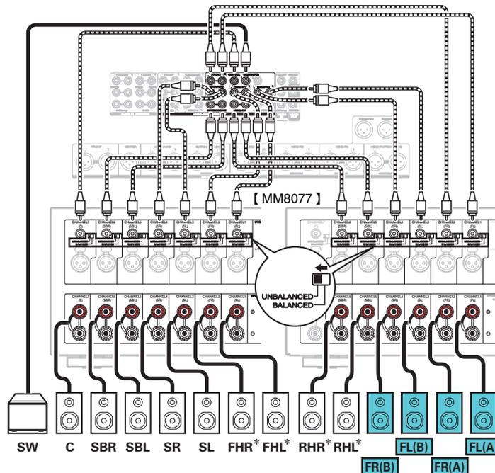
\* Los altavoces de altura, altavoces de techo y altavoces Dolby Atmos Enabled se pueden enchufar a los conectores HEIGHT1 y HEIGHT2 RCA o a conectores HEIGHT1 y HEIGHT2 XLR. Establezca el altavoz que se vaya a conectar mediante la opción "Altura" del menú. (p. 225)
