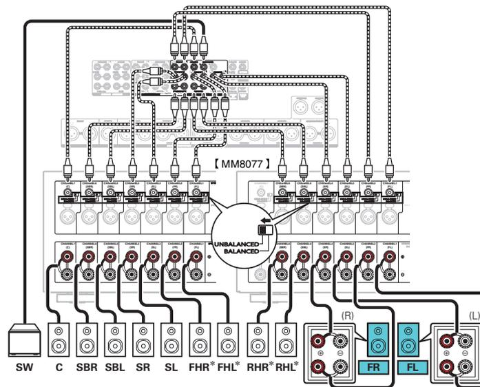
\* Los altavoces de altura, altavoces de techo y altavoces Dolby Atmos Enabled se pueden enchufar a los conectores HEIGHT1 y HEIGHT2 RCA o a conectores HEIGHT1 y HEIGHT2 XLR. Establezca el altavoz que se vaya a conectar mediante la opción "Altura" del menú. (☞ p. 225)
