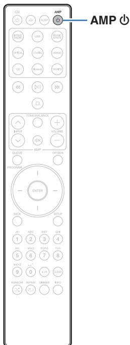
Puede configurar la unidad para que acceda automáticamente al modo de espera si no se registra funcionamiento durante 30 minutos cuando no hay entrada de audio (modo de espera automático).
